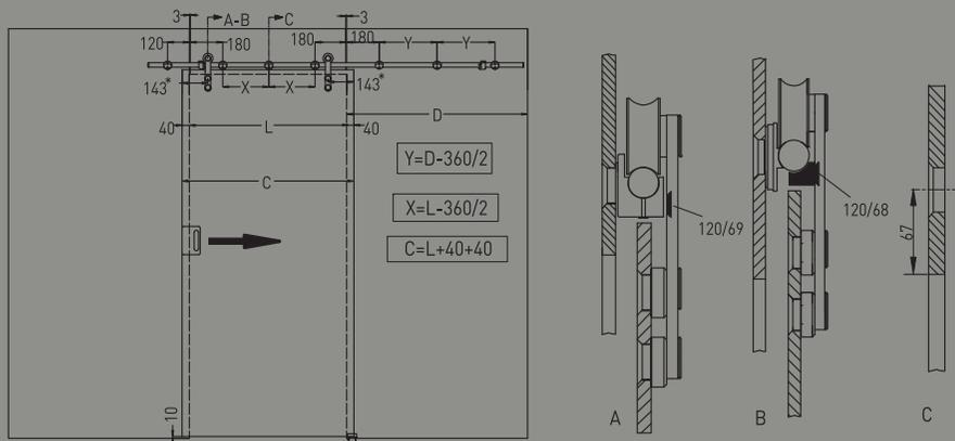
**A- Para instalación tipo A montar ref. 120/69**
